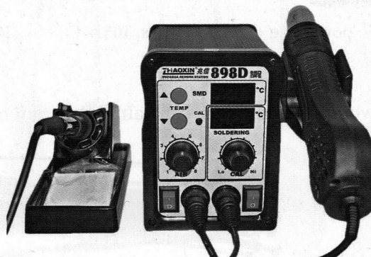
Rys. 105.7. Stacja lutownicza z Hot Air
