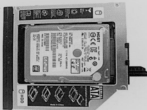
Rys. 101.4. Obudowa na dodatkowy dysk do laptopa
