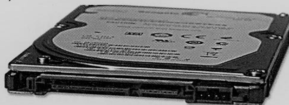
Rys. 101.3. Kontrolery dysku twardego 2,5 cala: a) kontroler ATA, b) kontroler SATA
