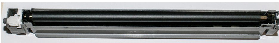
Ten, wydawałoby się, niepozorny element to jedna z ważniejszych części drukarki laserowej – rolka ładująca odpowiedzialna za naładowanie bębna, zanim ten zostanie „omieciony” promieniem laserowym w miejscach, w których ma przylgnąć toner.
