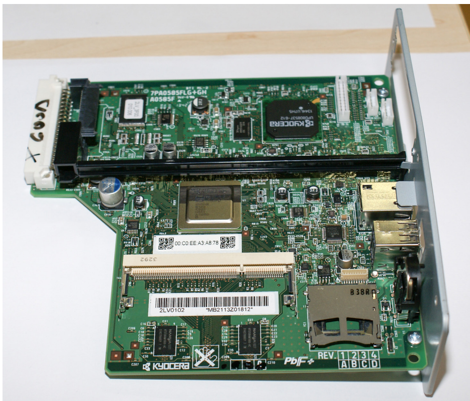
Płyta główna drukarki, widoczny główny procesor przetwarzający zadania wydruku, nieco niżej gniazdo na moduł pamięci typu SO-DIMM DDR 2.
