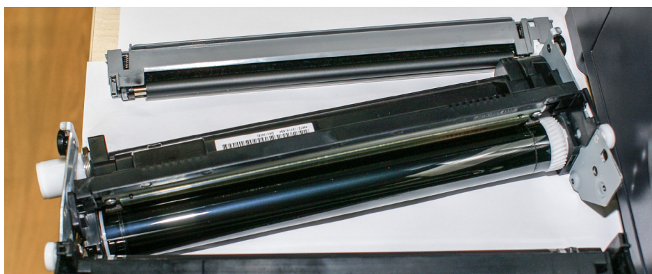
Bliźniaczy element to bęben drukarki (w tym przypadku charakterystyczny wygląd wynika z zastosowania powłoki ceramicznej stanowiącej patent japońskiej firmy Kyocera).
