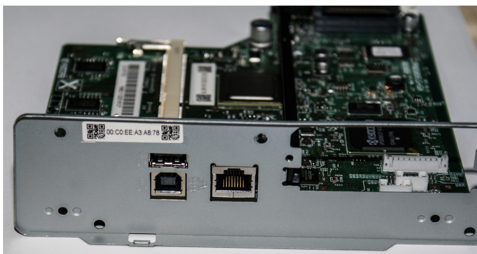
Wymontowana z drukarki elektronika z widocznymi gniazdami interfejsów komunikacyjnych: po lewej stronie od góry USB typu A, niżej USB typu B. Dalej na prawo standardowe gniazdko dla złącza sieciowego typu RJ-45. Widoczne po prawej stronie wycięcie przeznaczone jest na opcjonalny moduł rozszerzeń (np. zawierający interfejs bezprzewodowy).
