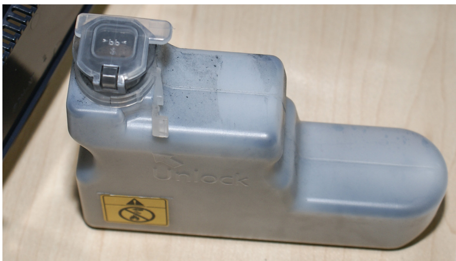
Cechą charakterystyczną drukarki laserowej jest pojemnik na zużyty toner. Do tego pojemnika trafiają resztki tonera, które pozostały na bębnie po przeniesieniu obrazu na papier.
