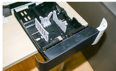
Szuflada podajnika papieru z regulowanymi prowadnicami pozwalającymi dopasować odpowiedni rozmiar nośnika (A4, A5, różnego typu koperty itd.) w zależności od oczekiwanych rezultatów druku. To tutaj zaczyna się droga kartki papieru w drukarce.
