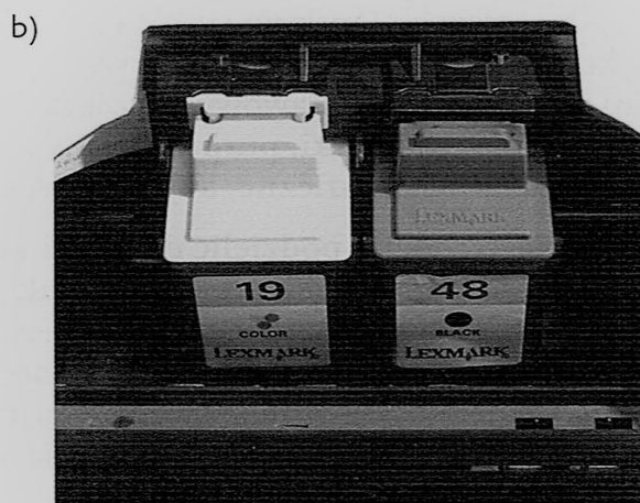
Rys. 70.2. Budowa drukarki atramentowej: a) tusze i głowica drukująca, b) kartridż ze zintegrowaną głowicą drukującą
