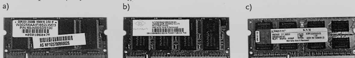
Rys. 87.8. Pamięci SO-DIMM: a) DDR, b) DDR2, c) DDR3
