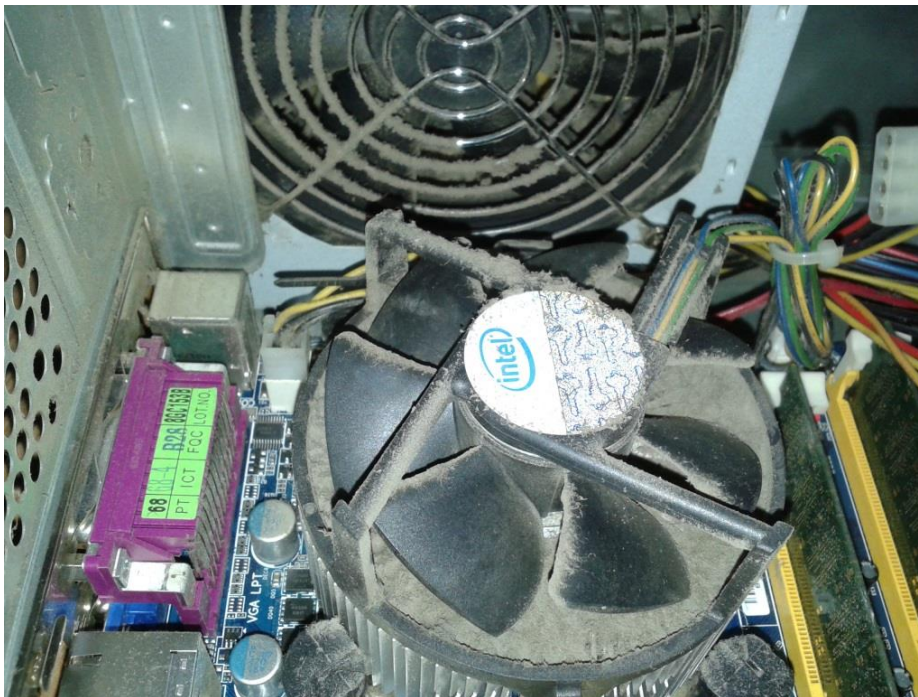
Rys. 8.1. Zanieczyszczenia występujące wewnątrz jednostki centralnej.
