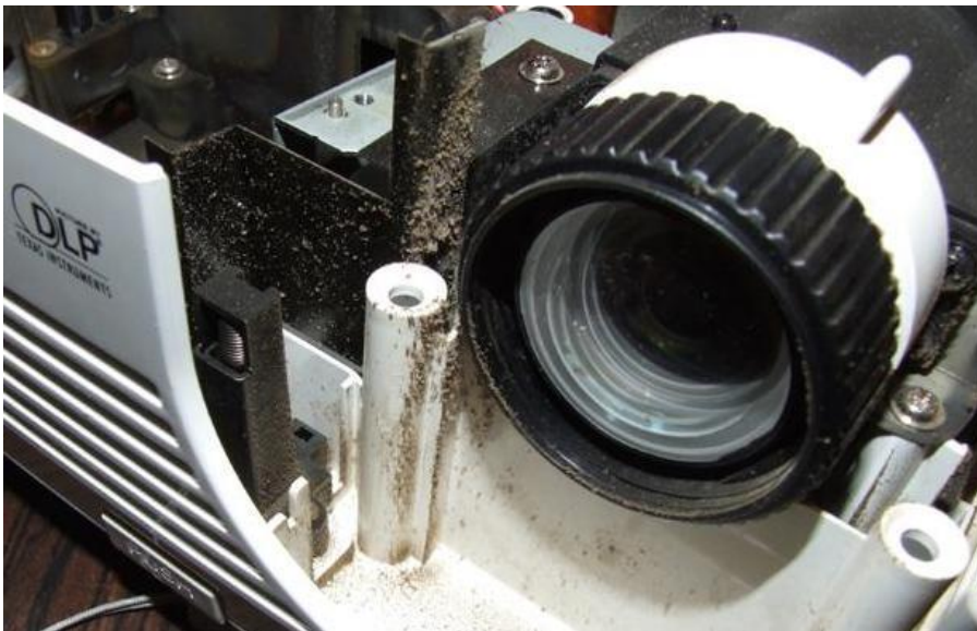
Rys. 8.5. Wnętrze projektora multimedialnego podczas konserwacji
