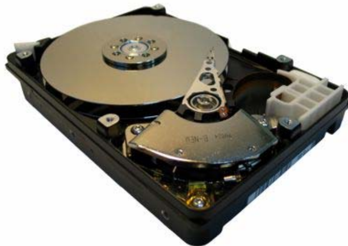
Rys. 5. Zdjęcie wnętrza dysku twardego. Widoczny: talerz, ramię głowicy i pozycjoner
