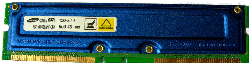
Rys. 9 Pamięć DIMM typu RDRAM
