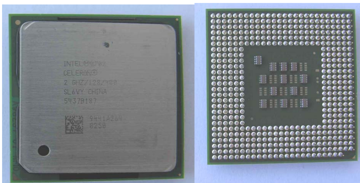
Rys. 4 Widok procesora Celeron®, przystosowanego do instalacji w gnieździe typu Socket 478
