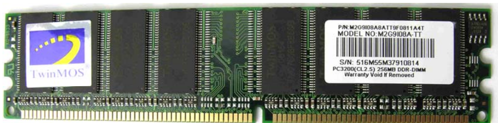
Rys. 8 Pamięć DIMM typu DDRAM
