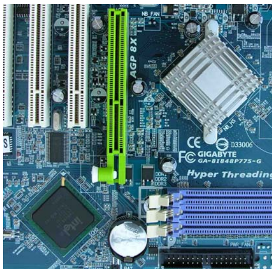
Rys. 15 Chipset płyty głównej Intel 848 P
