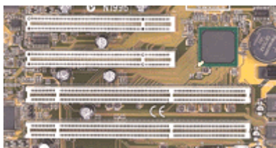
Rys. 11 Gniazda PCI, krótsze 32 bitowe od góry i dłuższe 64 bitowe (PCI-X) od dołu.
