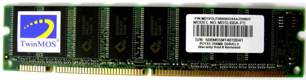
Rys. 7 Pamięć DIMM typu SDRAM
